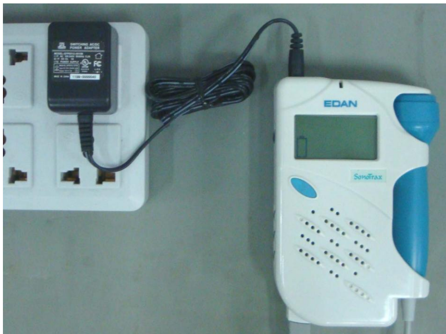
Abbildung 3-7 Laden des NiMH-Akkupacks
