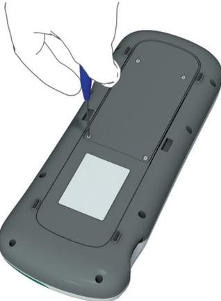
Nach dem Einsetzen eines neuen Akkus muss das Messgerät über Nacht aufgeladen werden, bevor Messungen durchgeführt werden.
