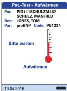
Das Thermometersymbol zeigt an, dass der Teststreifen aufgewärmt wird. Ein Signalton zeigt den Abschluss des Aufwärmvorgangs an (bei Aktivierung der Signaltöne).
