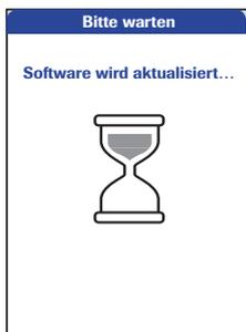
Software-Updates werden über das DMS installiert. Das Gerät akzeptiert die vom DMS ausgelösten Updates nur, wenn es sich im Leerlaufbetrieb befindet und wenn mindestens drei Segmente des Batterie-Symbols leuchten. Während eines Updates sieht die Anzeige wie in der nebenstehenden Abbildung aus.
