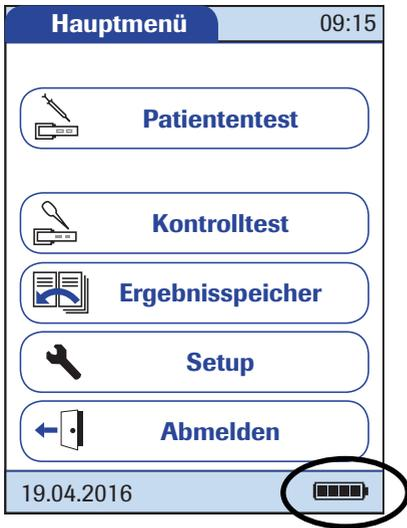
Im Akkubetrieb zeigt das Messgerät ständig den Ladestatus des Akkus an. Das Akkusymbol besteht aus vier Segmenten, die die Akkuladung anzeigen.
