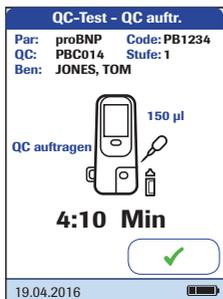
Das Pipettensymbol zeigt an, dass das Gerät messbereit ist und die Probe aufgetragen werden kann.
