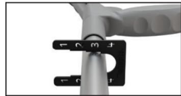
2. Compare sus medidas con la figura para determinar si su muleta necesita una de las fundas adaptadoras incluidas. Deje a un lado las fundas adaptadoras correspondientes para el próximo paso de montaje.
