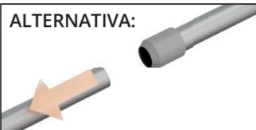
**4.** Deslice el sistema inferior en el tubo inferior de la muleta y encaje el sistema superior en el extremo superior del tubo. A continuación, vuelva a colocar la base de goma en el tubo de la muleta o junte los tubos. Utilice la llave hexagonal para apretar los tres tornillos y fijar el STEETS Steady Stand al punto más bajo y más alto del tubo de la muleta.
