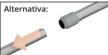
**4.** Fai scorrere il sistema inferiore sul tubo inferiore del bastone e aggancia il sistema superiore all'estremità superiore del tubo. Successivamente, rimetti il piedino di gomma sul tubo del bastone **o** riassembra i tubi. Usa la chiave esagonale per stringere le tre viti e fissare il STEETS Steady Stand nei punti più basso e più alto del tubo del bastone.
