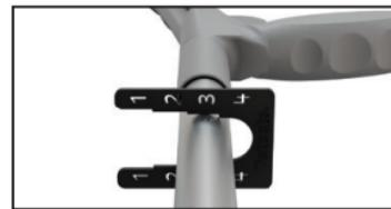
2. Vergelijk uw metingen met de illustratie om te bepalen of en, indien nodig, welke adapterhulzen nodig zijn voor de onderste en bovenste delen van uw kruk. Maak de juiste adapterhulzen klaar voor montage.
