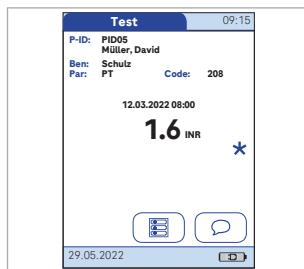
**3** Werte, die oberhalb oder unterhalb des Messbereichs liegen, werden durch das Symbol > (oberhalb) bzw. < (unterhalb) gekennzeichnet.
