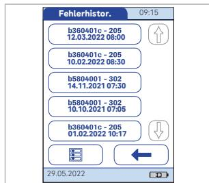
Eine Übersicht der Fehler, die auf dem CoaguChek® Pro II Gerät aufgetreten sind, können Sie im Bildschirm *Fehlerhistor.* unter folgendem Pfad aufrufen und durchblättern:
