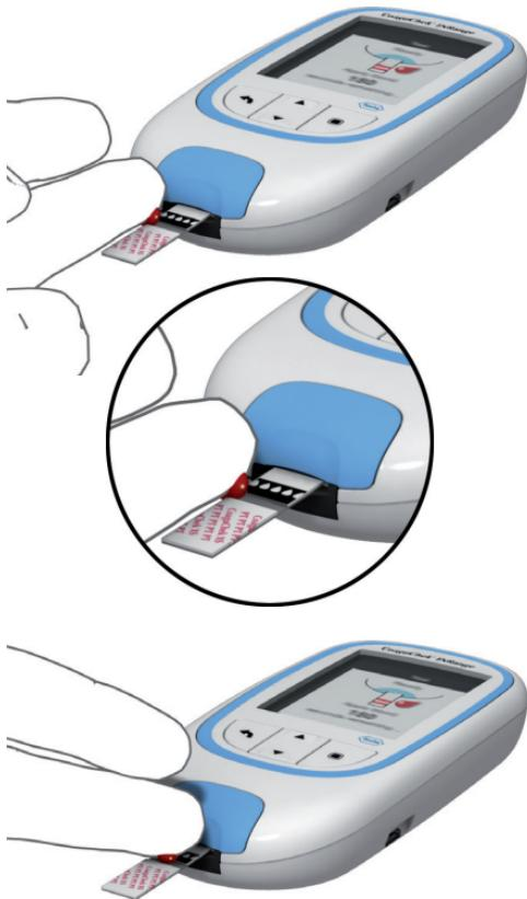
**13** Tragen Sie das Blut direkt vom Finger auf, indem Sie den Blutstropfen seitlich auf das halbrunde durchsichtige Probenauftragsfeld des Teststreifens aufbringen.
