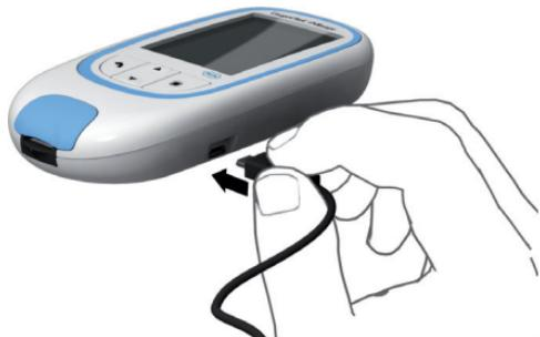
Um das Gerät mit einem Computer zu verbinden, benötigen Sie ein geeignetes USB-Kabel (im Lieferumfang enthalten). Verbinden Sie den USB-Stecker (Typ B) mit dem Gerät und den USB-Stecker (Typ A) mit dem Computer. Der USB-Port befindet sich an der rechten Seite des Gehäuses. Sie müssen für die Datenübertragung das Kabel immer zuerst mit dem Gerät und erst dann mit dem Computer verbinden.
