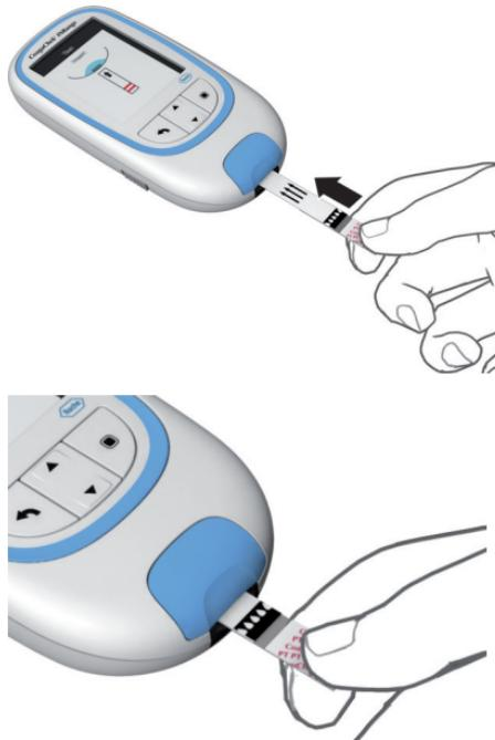
Das Teststreifen-Symbol fordert Sie jetzt auf, einen Teststreifen einzuschieben.
